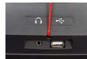
汗の影響を考慮して配置された ヘッドフォン端子・USBポート
