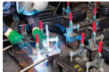
ジグ溶接 LSシリーズは溶接時の安定性と精度を確保するためにジグを使用。
