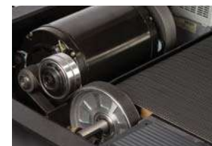
特許取得済みの ドライブベルト自動調節機能
